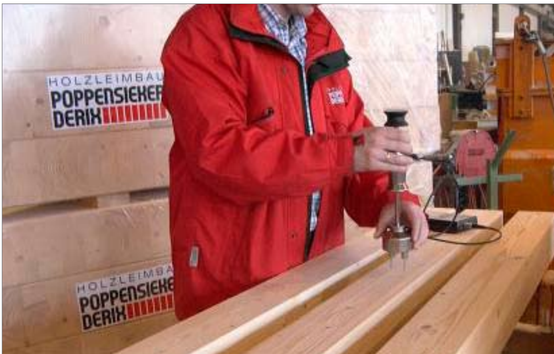
Bild 6: Messung der Holzfeuchte (Fa. Derix)
