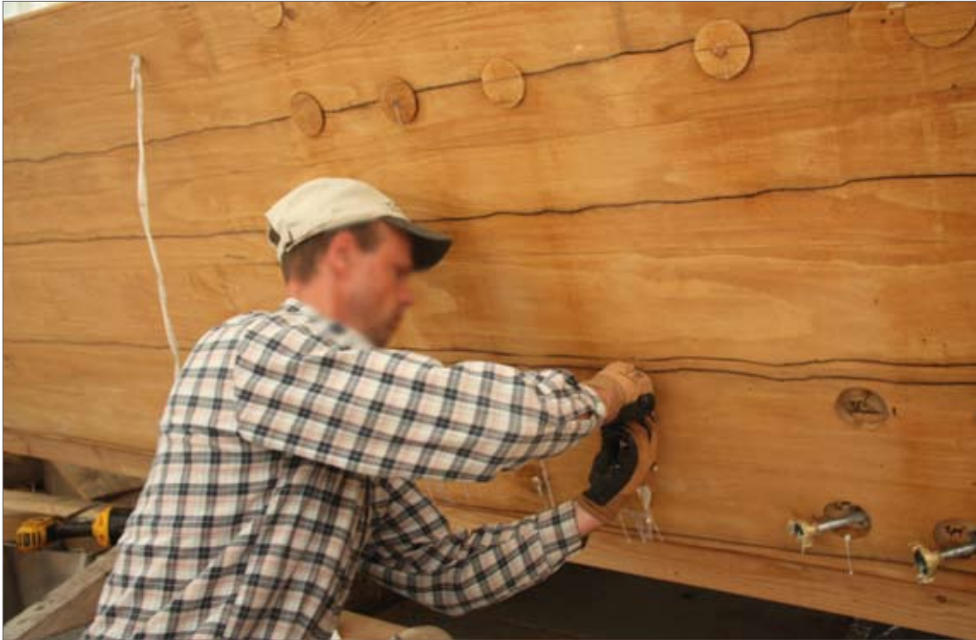
Bild 26: Zwei eingebrachte Hohlbohrer mit der Schlauchkupplung (Fa. Schaffitzel)
