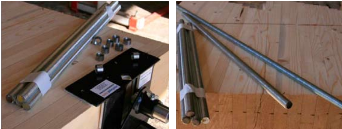
Bild 2 u. 3: Stahlstäbe zum Einkleben in Holzbaustoffe
