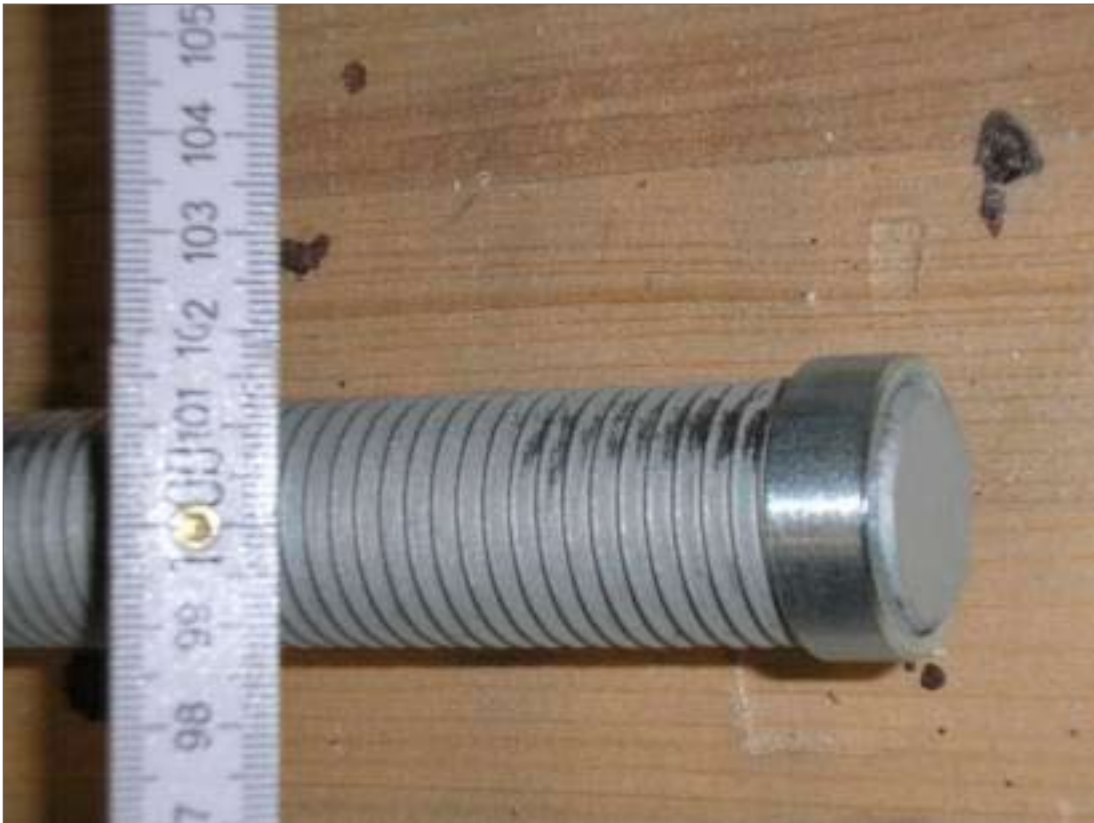
Bild 7: Stahlstab mit Distanzring (Fa. Grossmann)
